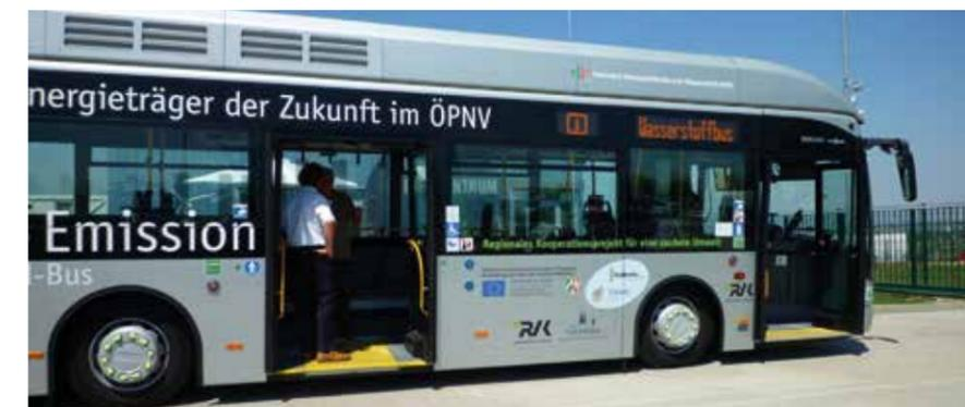
Wasserstoffbus mit Brennstoffzellenantrieb
